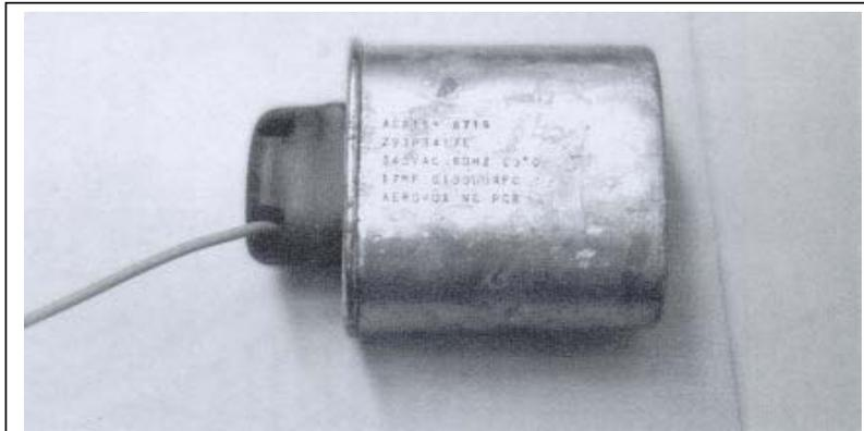
Esistono condensatori, tipo quello sopra riportato in foto, che non contengono PCB, e tale informazione (scritta NO PCB) è riportata incisa sull'etichetta del trasformatore. Nell'etichetta è riportata anche l'informazione che il condensatore è stato realizzato la 19<sup>a</sup> settimana del 1987. (fonte [http://www.ec.gc.ca/pcb/pcb23/eng/s4\\_e.htm](http://www.ec.gc.ca/pcb/pcb23/eng/s4_e.htm))
