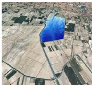
T = 16 ore; quota di riempimento = 20 m s.l.m.
