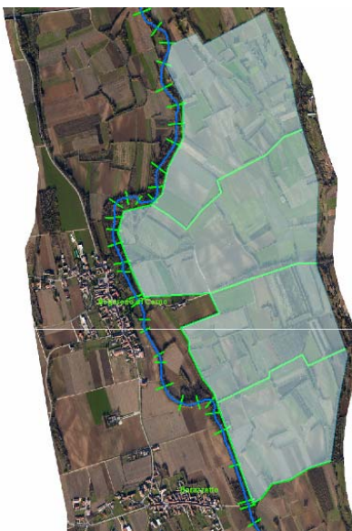
Figura 7.5.2.1: ipotesi di suddivisione in sottocasse della cassa di Nogaredo di Corno
