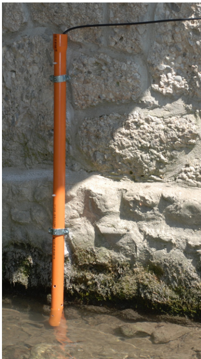
Figura 6.3.3: a sinistra: l'idrometro di Barazzetto. A destra: l'idrometro di Zompicchia. Il tubo arancione protegge lo strumento e lo mantiene in posizione
