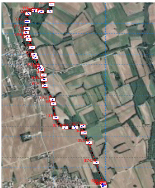
Figura 6.6.1: rappresentazione delle sezioni trasversali individuate e inserite nel modello numerico monodimensionale
