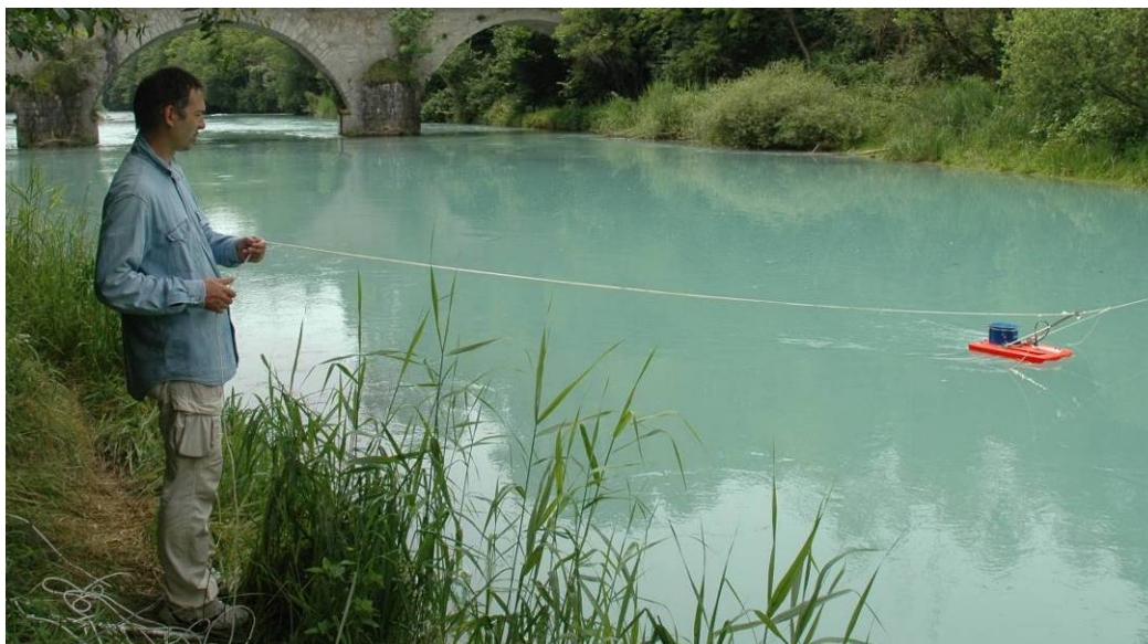
Figura 6.3.8: esecuzione di misure di portata e batimetriche nel torrente Corno
