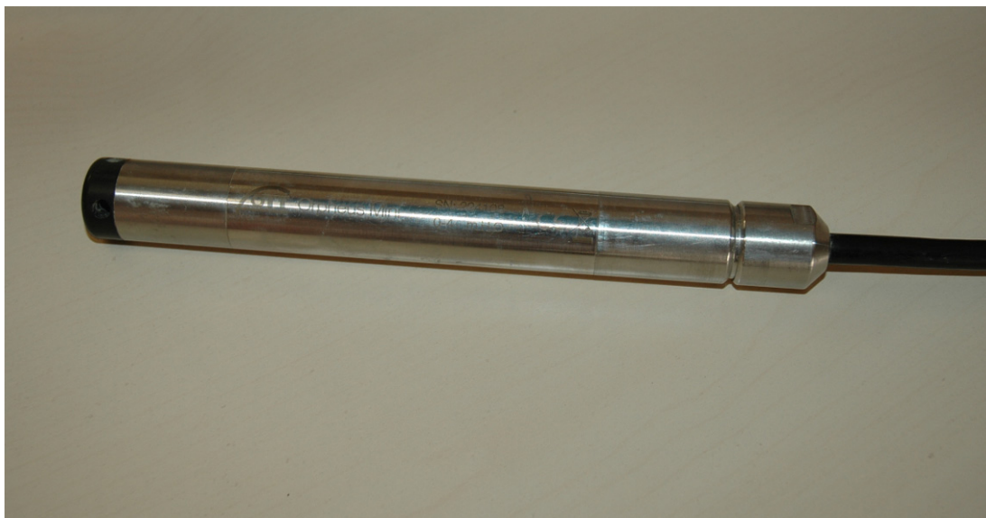
Figura 6.3.4: particolare del sensore di pressione denominato “Orpheus mini”, utilizzato nell’idrometro di Zompicchia
