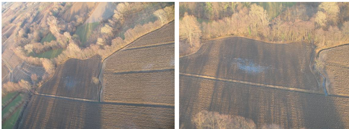
Figura 5.3.3.8: esempio di sistemazione agraria con capifosso e scoline per raccogliere le acque in eccesso
