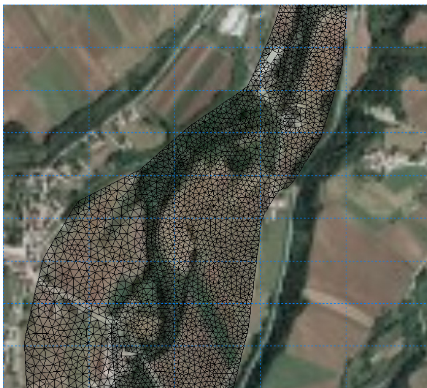
Figura 6.6.3: mesh triangolare non strutturata, realizzata per la descrizione del territorio soggetto ad esondazione da parte del torrente Corno
