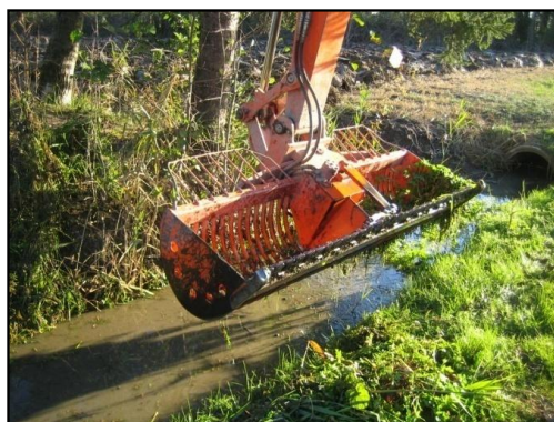
Attività di sfalcio svolta utilizzando benne sfalcianti montate su escavatore
