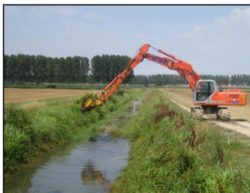
Attività di sfalcio svolta utilizzando benne sfalcianti montate su escavatore
