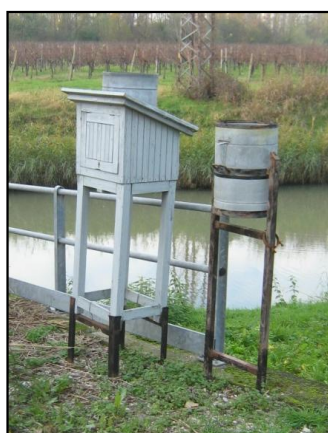
Esempi di pluviometri: a sinistra, un pluviometro automatico, a destra, un pluviometro manuale
