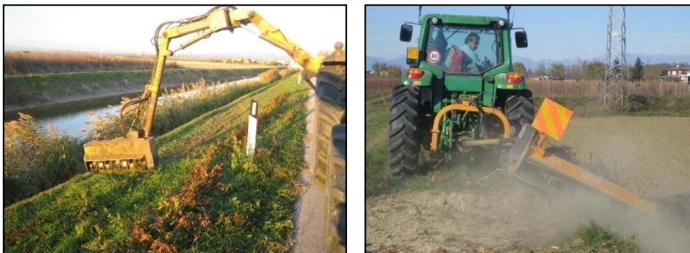
Decespugliamento di scarpate di canali e sponde argini con trinciastocchi
