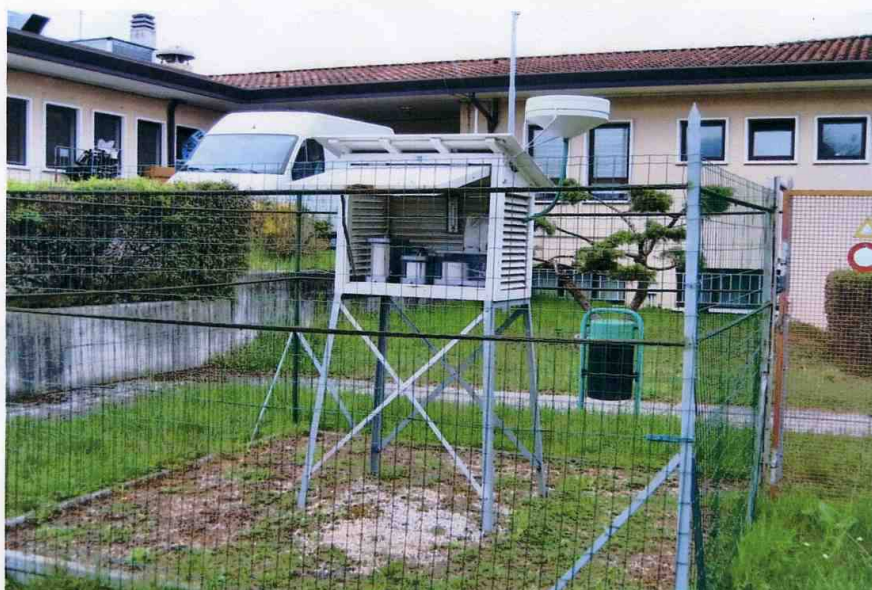
CAPANNINA METEO CON IMBUTO RACCOGLITORE PIOGGE ESTERNO
