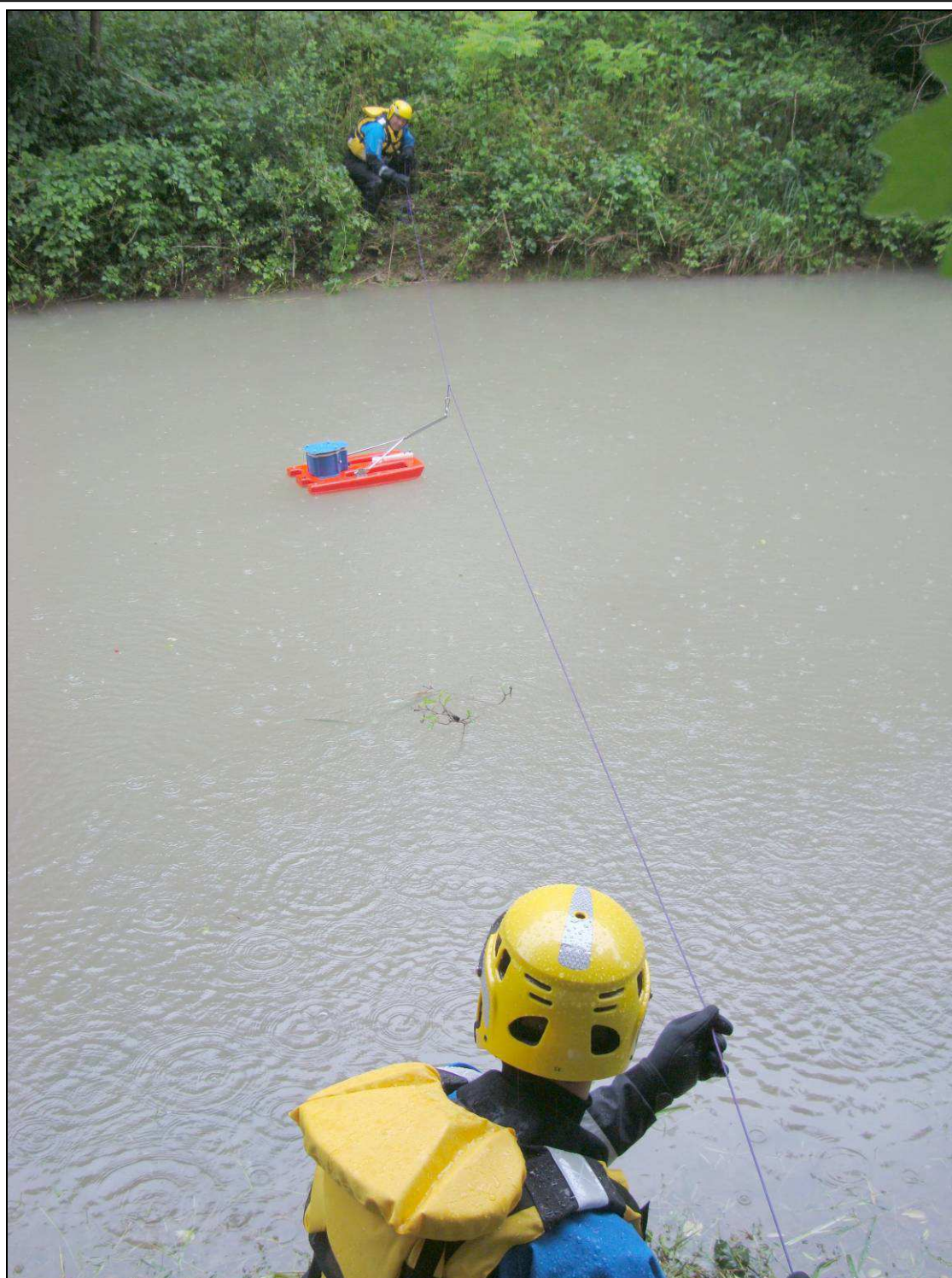
Figura 125 - misura di portata con l'utilizzo di ADCP montato su natante
