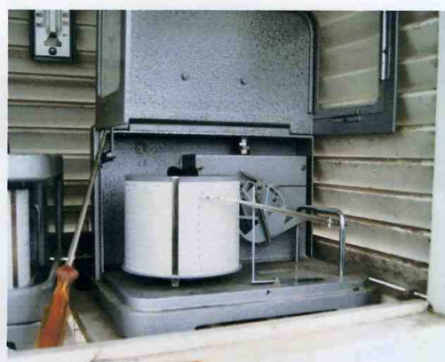
DETTAGLIO PLUVIOGRAFO SIAP
