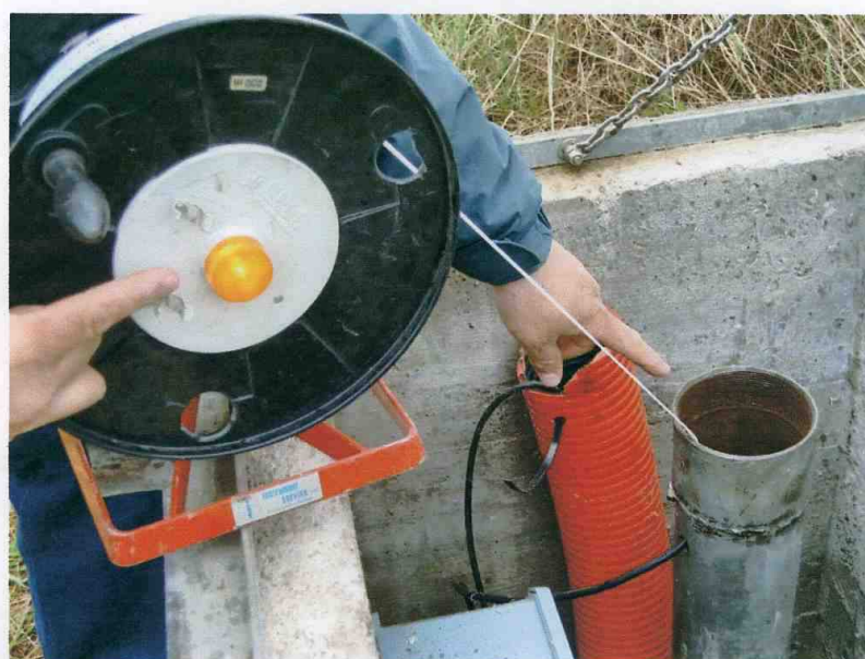
MISURA FREATIMETRICA IN POZZO CON SCANDAGLIO
