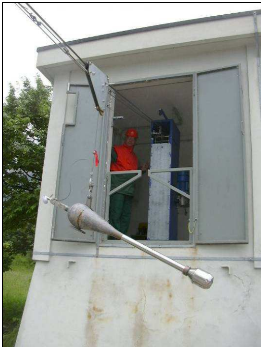
Figura 124 - Stazione di misura della portata di Piovorno dotata di impianto di teleferica
