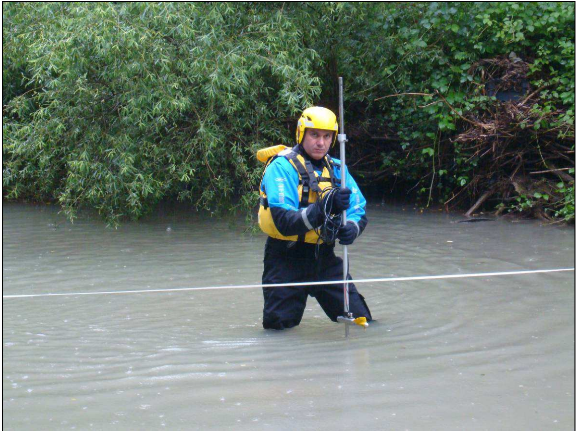
Figura 123 - Operatore U.O.I. durante una misura di portata al guado con correntometri a elica
