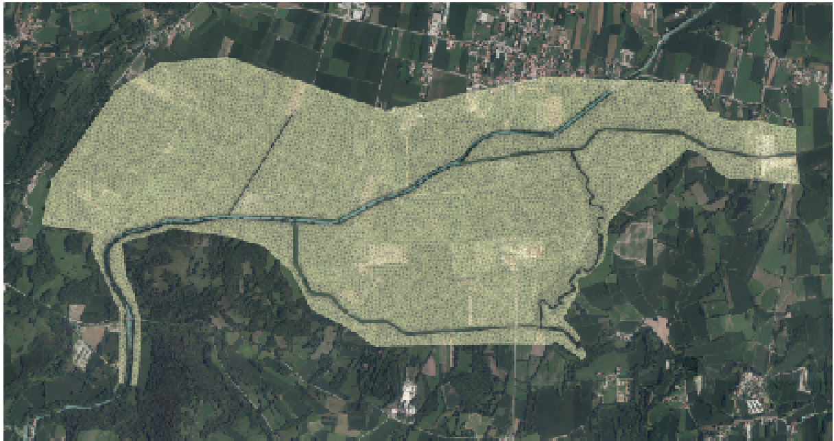
Figura 34 - Onda di Piena del torrente Corno per TR 200 - bacino chiuso dell'area del Paludo
