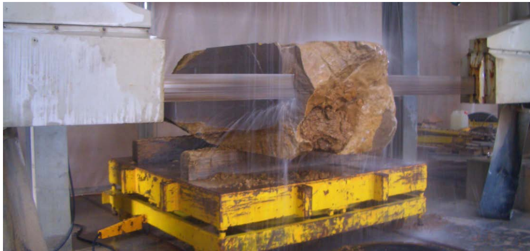
Blocco di Repen Classico Zolla: durante la riquadratura con taglio al filo statico ed a termine operazione (Cava Babce Nord, TS)
