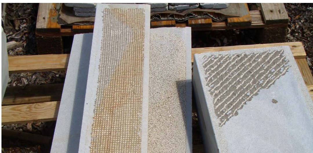
Trattamento della superficie mediante "fiammatura" manuale e "bocciardatura" della Pietra Piasentina
