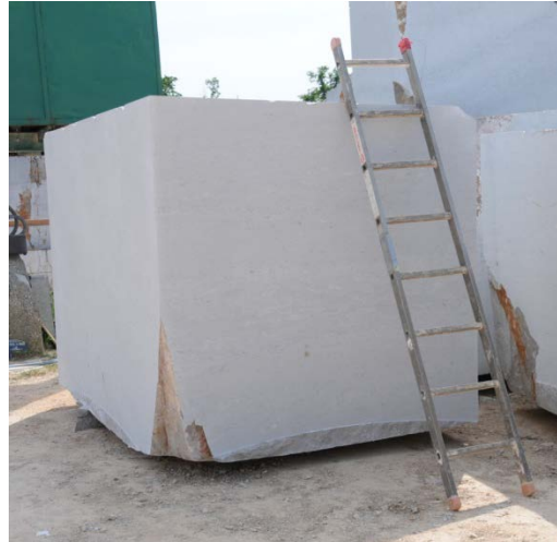
Blocco di Repen Classico Zolla: durante la riquadratura con taglio al filo statico ed a termine operazione (Cava Babce Nord, TS)
