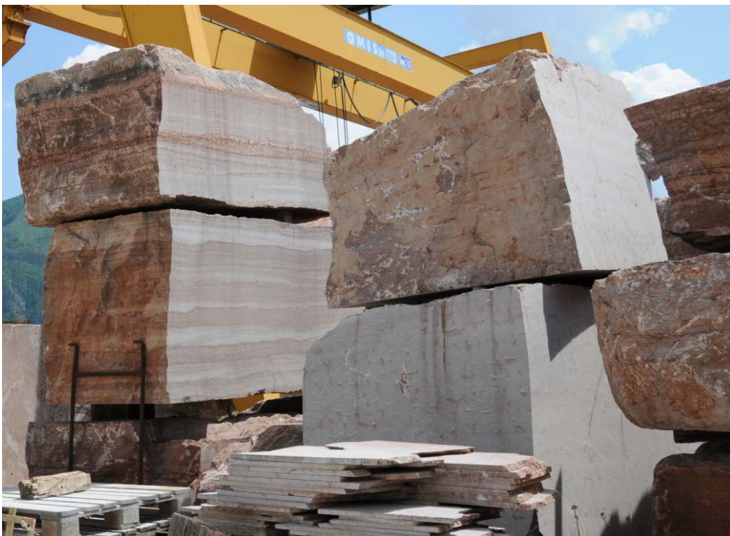
Blocchi di "Noce Radica" di Verzegnis in fase di riquadratura ed in deposito (Cava Monte Lovinzola, UD)
