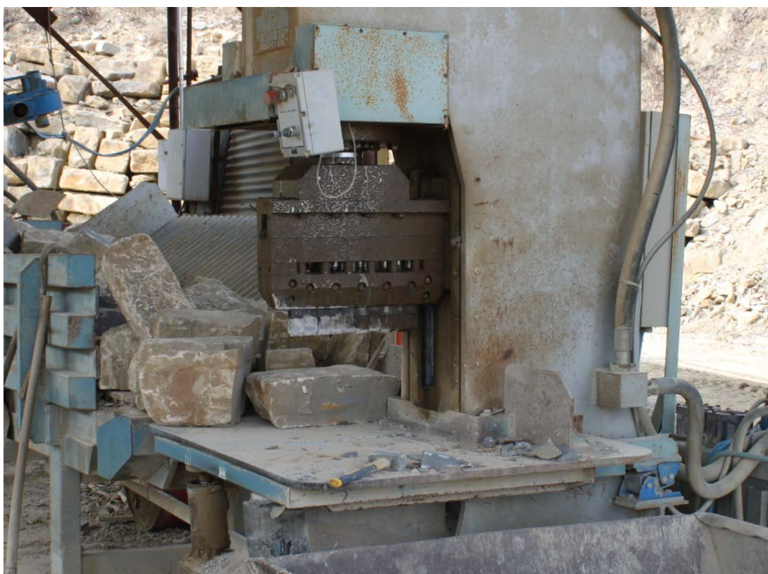
Lavorazione "a spacco" del masegno di Muggia (TS)
