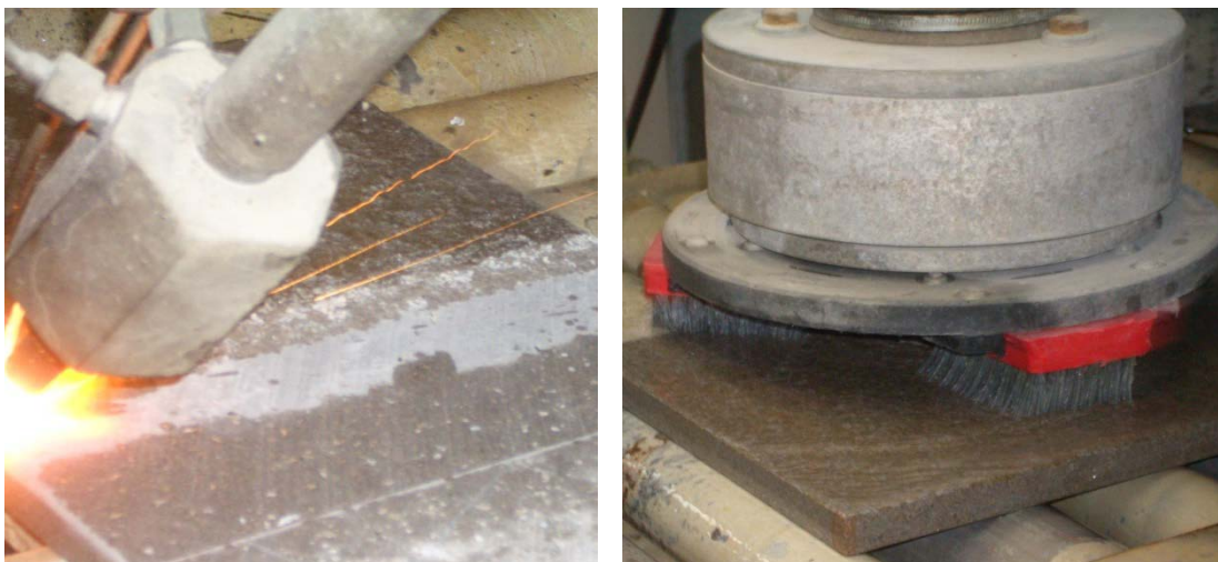
Trattamento della superficie mediante "fiammatura e spazzolatura" automatizzate della Pietra Piasentina (Ditta Julia Marmi di Laurino M. e C., UD)
