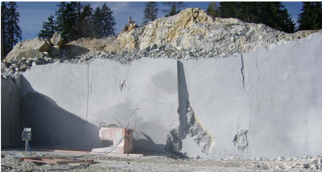
Coltivazione con filo diamantato nella cava del marmo "Grigio Naguscel Carnico" (Cava Clap di Naguscel, UD)
