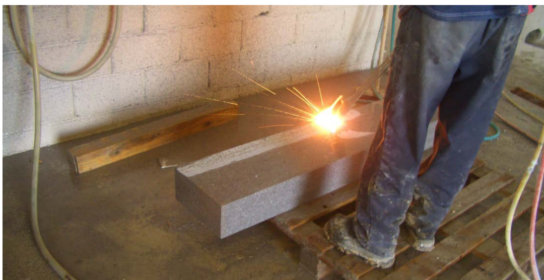
Trattamento della superficie mediante "fiammatura e spazzolatura" automatizzate della Pietra Piasentina (Ditta Julia Marmi di Laurino M. e C., UD)
