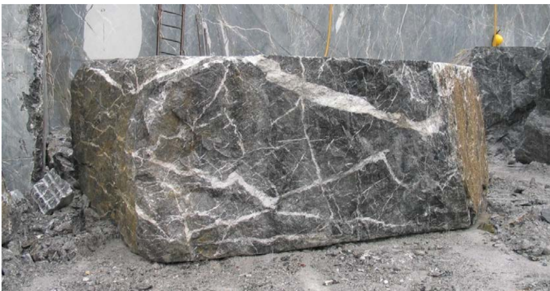
Coltivazione per bancate alte di marmo "Grigio Carnico": blocco risultante dopo il ribaltamento sul piazzale (Cava Pramosio, UD)
