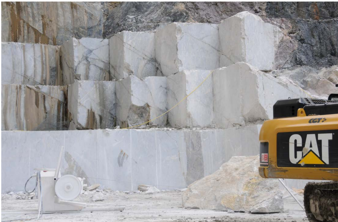
Riquadratura in cava di un blocco di Fior di Pesco (Cava Avanza, UD)
