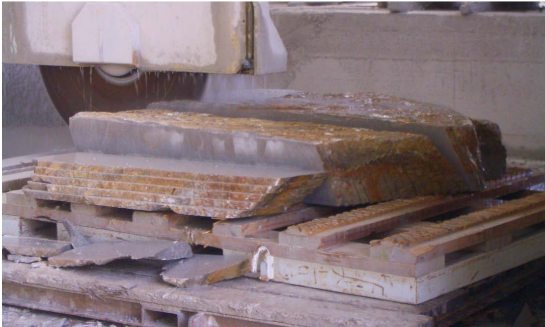
Produzione delle filagne da riquadrare di Pietra Piasentina presso il laboratorio della Ditta S.A.P.T. di Cecino e C. (UD)
