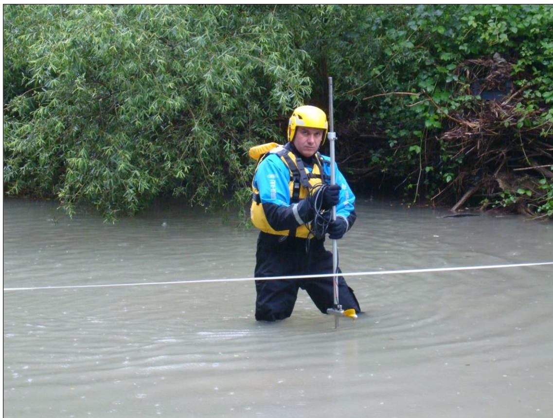
Figura 100 - Operatore U.O.I. durante una misura di portata al guado con correntometri a elica
