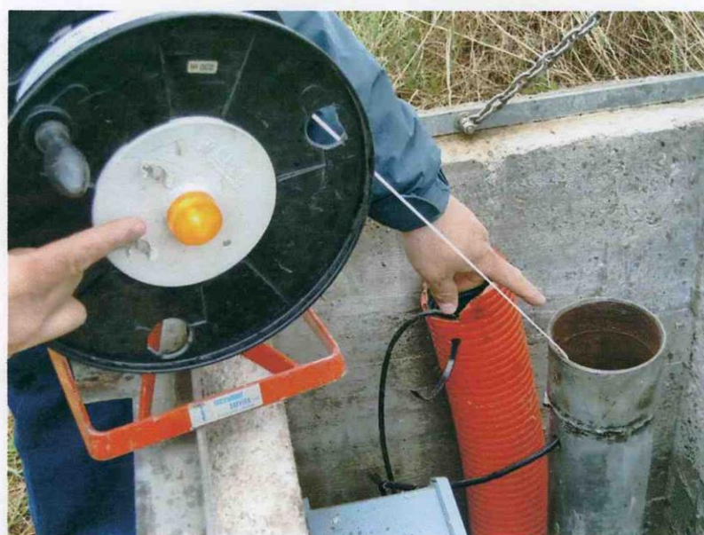
MISURA FREATIMETRICA IN POZZO CON SCANDAGLIO
