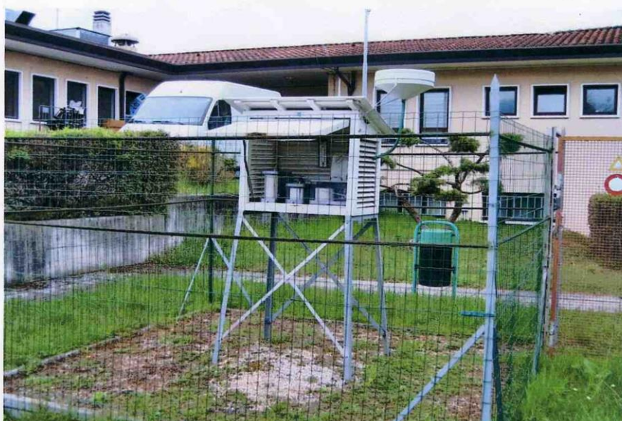
CAPANNINA METEO CON IMBUTO RACCOGLITORE PIOGGE ESTERNO
