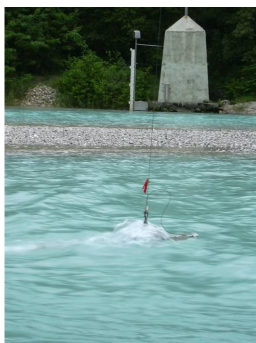
Figura 101 - Stazione di misura della portata di Pioverno dotata di impianto di teleferica
