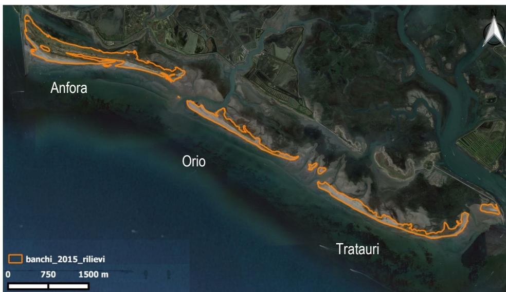
Figura 4.52. I banchi sabbiosi della laguna di Grado nel 2015 (immagine da Google Earth, data acquisizione immagini: 12/07/2015): in evidenza la linea di riva dei banchi tracciata grazie ai rilievi GPS effettuati nel mese di giugno 2015.
