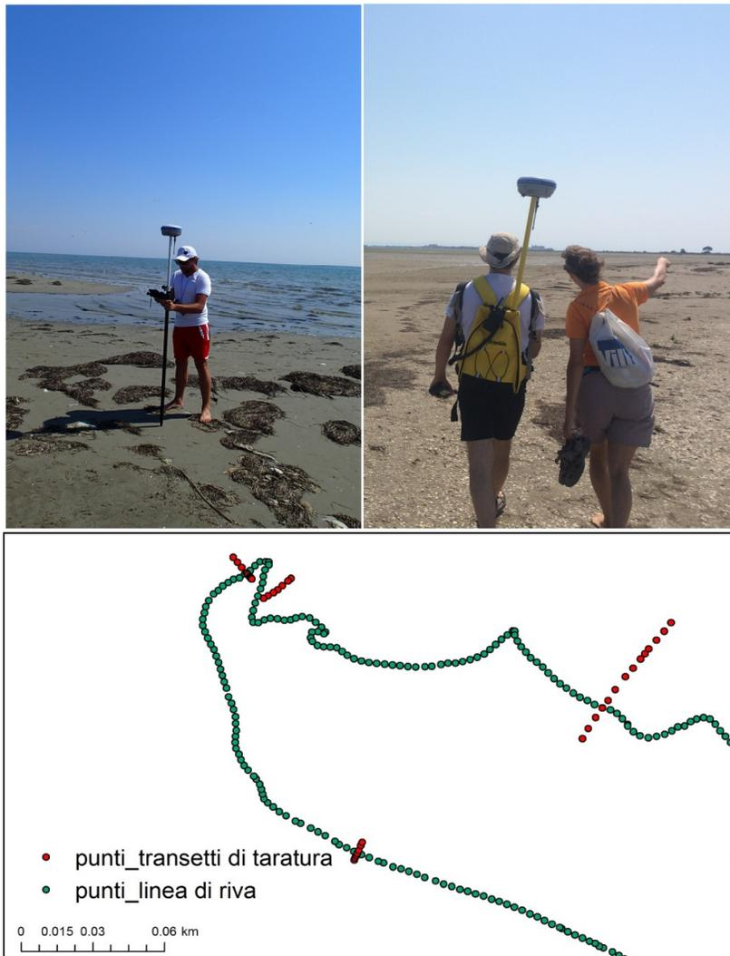
Figura 4.45. Operazioni di rilevamento topografico dei banchi d'Anfora, d'Orio e dei Tratauri di giugno 2015.
