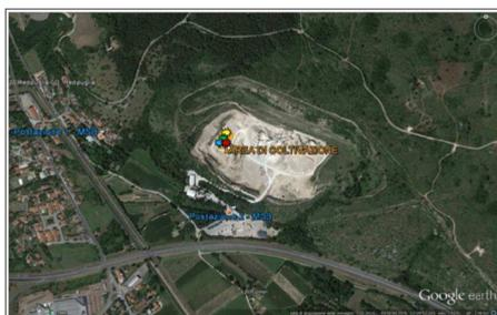
Figura 46 Ubicazione punti di misura delle vibrazioni e posizione delle volate nel 2015 (trattasi di foto aerea scattata prima dello spostamento dell'impianto nella collocazione attuale)
