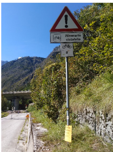
Esempi di segnaletica turistica non conforme di tipo particolare: segnale turistico recante la numerazione dell'itinerario Bicitalia, segnale di direzione per punto di interesse di tipo urbano, segnale di indicazione per punto di assistenza, da indicarsi come altro.
