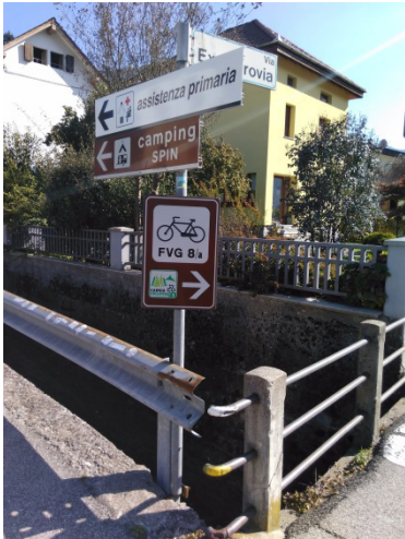
Esempi di segnaletica turistica conforme: segnale di direzione e conferma ad alta visibilità (40x60), segnale di direzione e conferma standard (15x35), segnale di direzione per punto di interesse standard (15x35).
