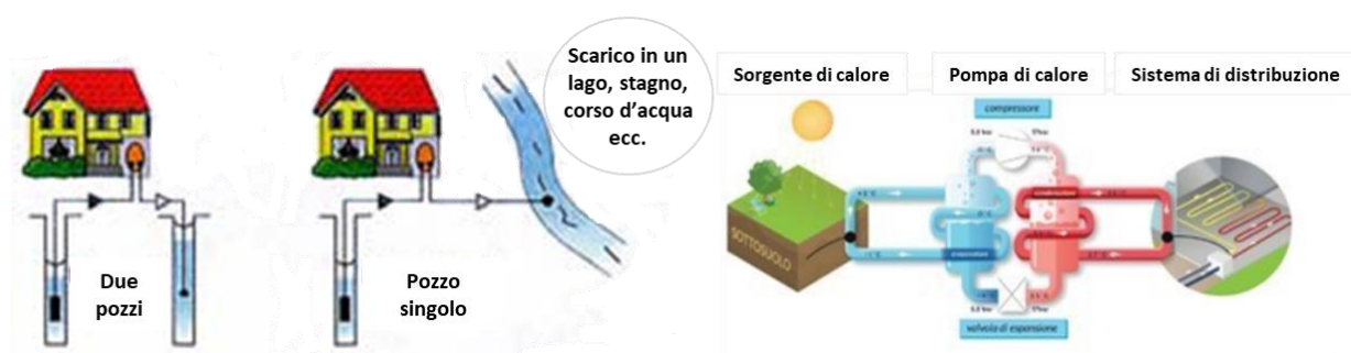
Figura 4.16. Sistema geotermico open loop a sonde geotermiche verticali, a destra schema pompa di calore geotermica (PdC) 22 .
