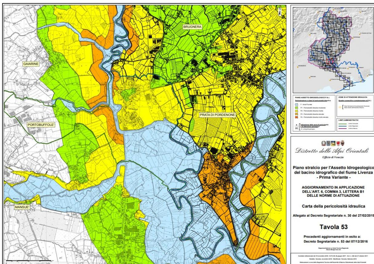
Figura 5.6 Estratto della carta della pericolosità idraulica del Piano stralcio per l'assetto idrogeologico del bacino idrografico del Fiume Livenza
